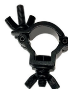
WORKiW C 205 B Color: Aluminio o Negro. Garra/Abrazadera especial para tubo de 20 mm de la estructura WCAD. Carga 10 Kg. Negro.
