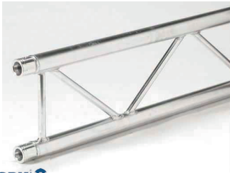
WORKiW WPX 29/100 Color: Aluminio o Negro. Tubo 50 mm. Grosor 2 mm. Longitud 100 cm.
