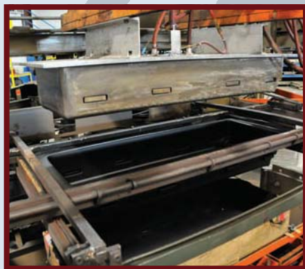
Molde termo-formado (vacuum) de los estuches para teclados.
