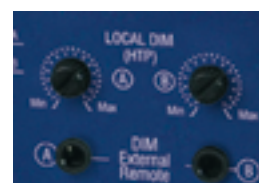
Control local de dimmerización (DUODIM).
