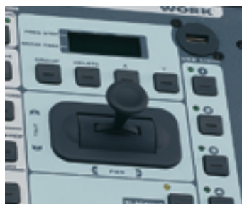
Interfaz de creación y edición de escenas. Ergonómico joystick para patchear canales PAN/TILT.
