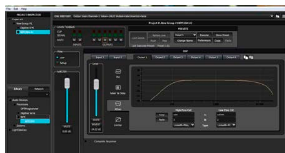
Configuración de Crossover (filtro paso-bajo y paso-alto). Con selección de distintas curvas y magnitudes.
