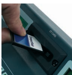
Slot lector/grabador de tarjetas Compact Flash (CF) 32 MB.
