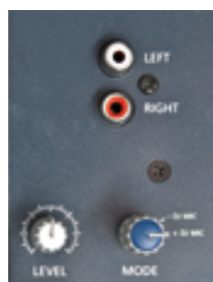
Entrada LINE en el panel frontal para conectar un reproductor externo.
