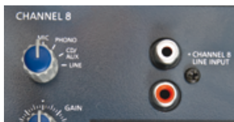
Entrada LINE en el panel frontal para conectar un reproductor externo.
