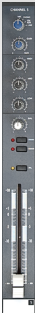
Entrada LINE en el panel frontal para conectar un reproductor externo.
