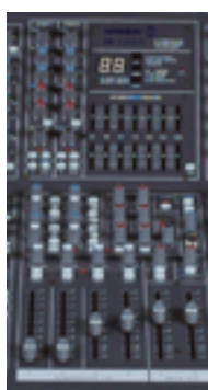
Sección Master con controles auxiliares, subgrupos, DSP y faders L/R por separado
