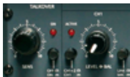
Función TALKOVER con control de sensibilidad. Selector para agrupar las entradas.
