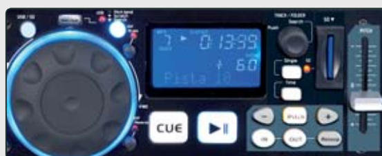
Jog wheel y pantalla LCD de gran formato con múltiples líneas de información. Slot para tarjetas SD.
