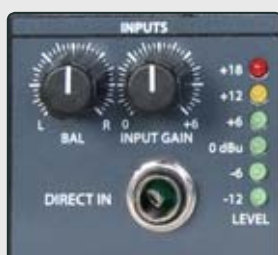
Entrada directa. Conexión frontal y trasera. Control de ganancia y balance.
