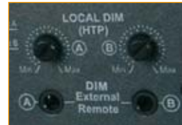
Control local de dimmerización (DUODIM).
