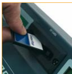
Slot lector/grabador de tarjetas Compact Flash (CF) 32 MB.
