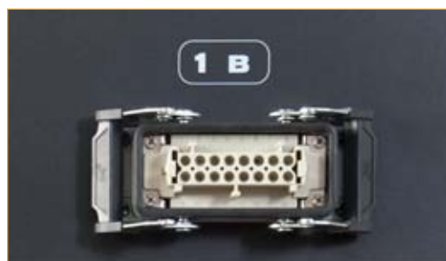
Conectores harting de 16 contactos cada 6 canales de dimmer.
