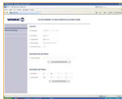
WEB SERVER integrado que permite configurar ambas unidades ( LM 3E y LM 3R ). Es posible ajustar la dirección IP y la descripción de la unidad.
