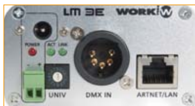
Panel frontal de LM 3E y LM 3R con su conexionado LAN, selector de grupo y LEDs testigo de señal DMX y Ethernet.
