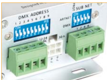
2 salidas RGB de 5A por color (total 30A). Dip Switch para selección de dirección DMX o selección de máscara de red según el modo de funcionamiento (DMX o ArtNet).
