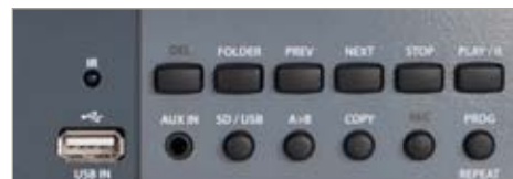
Puerto USB, sensor IR y controles de selección de carpetas, navegación entre pistas y programación.
