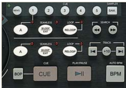
Selección de efectos, edición de modos CUE, LOOP, búsqueda de pista y control BPM.
