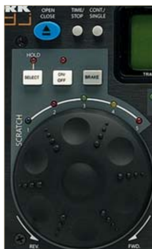
Rueda Jog wheel de gran formato con selección de efecto (SCRATCH, FLANGER, ECHO, etc).
