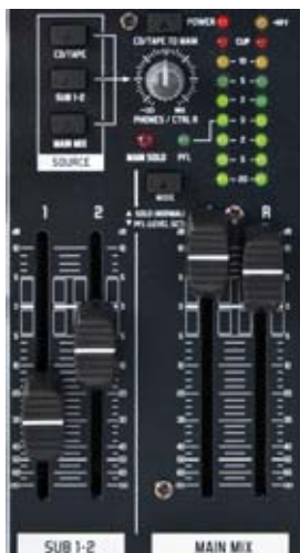
2 submasters y salidas L y R con fader individualizado.
