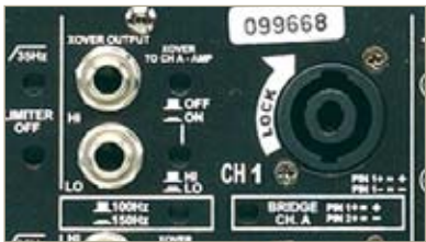
Salida en potencia Full-Range o dos vías a través de crossover.
