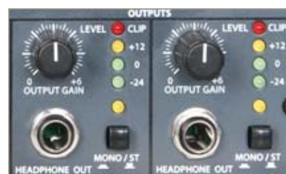
Controles individuales de cada canal. Conexión frontal, control de ganancia y selector MONO/ST.
