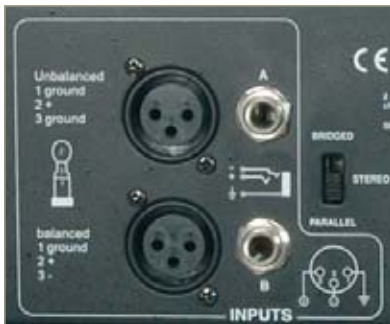
Sección de entrada con conectores XLR3 y Jack 1/4". Selección de modo de funcionamiento.
