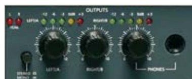
Control MASTER L/R separado. Toma de auriculares.
