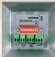
IC 6 PRO A. Conexión y selección de canal DMX.
