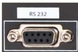
Conexión RS 232 para control externo de funciones.
