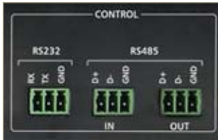
Interfaz de recepción de comandos de control vía protocolo RS 232 y RS 485.
