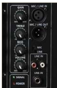
Controladores en la parte trasera de las cajas acústicas.
