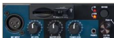
Puerto USB y Slot para tarjetas SD. Entrada MIC adicional.
