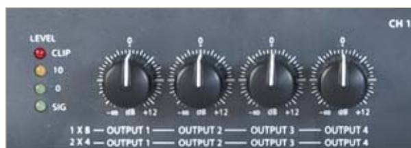
Controles frontales de 1 canal. Dependiendo del modo de funcionamiento controlan un tipo de salida.
