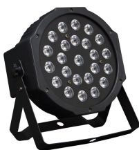
AMS PAR 24 RGB Proyector iluminación. 24 LED RGBW 1 W. 5/8 canales DMX. Apertura 25°.
