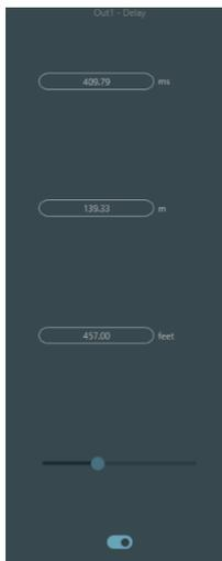
**Botón de activación:** Active el módulo de retardo designado en los módulos e insértese en la ruta de la señal de audio para aumentar el tiempo de retardo fijo para las señales.
