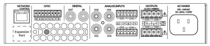
Los amplificadores Synthea incorporan una fuente de alimentación universal conmutada y pueden utilizarse con una tensión de entrada de red de 100 V CA a 240 V CA, 50/60 Hz. Utilice el cable de alimentación suministrado con el amplificador.
