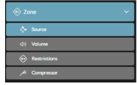
La pestaña ZonaS permite definir y nombrar zonas de instalación y acceder a otros submenús. Las zonas pueden ser áreas de instalación o habitaciones diferentes. En todos los menús de la pestaña Zona, la zona de instalación que se está configurando se selecciona resaltando uno de los identificadores de zona (A, B, C o D) en la parte superior de la pantalla.
