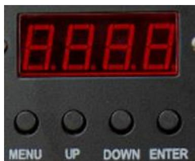
Pulse el botón MENÚ una vez para entrar en MENÚ, utilice los botones ARRIBA y ABAJO para desplazarse hasta la función deseada (según el siguiente cuadro) y pulse OK para confirmar la selección.
