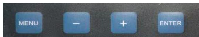
MENÚ: Presione brevemente para cambiar la interfaz, presione durante 3 segundos para cambiar a la interfaz de configuración avanzada.
