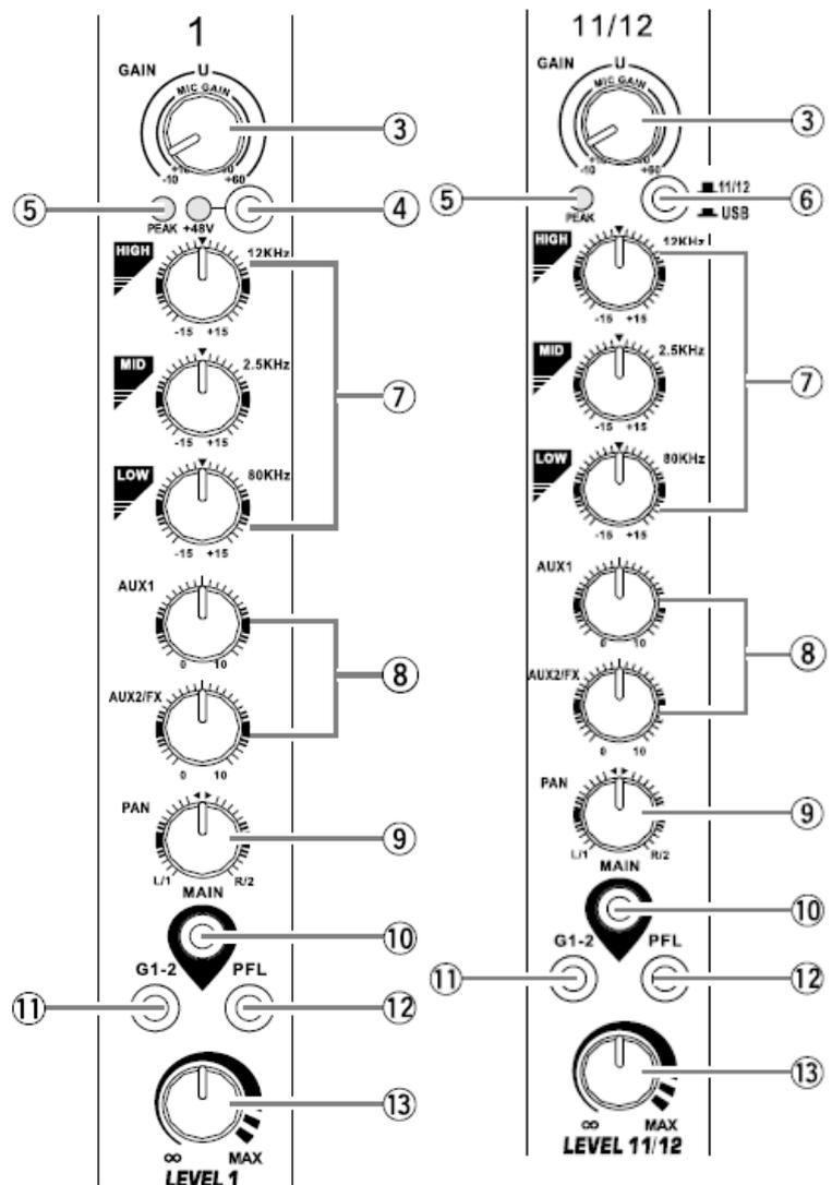
derecha se amplifica la banda de frecuencia correspondiente, mientras que girando a la izquierda se atenúa la misma.
