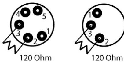
Para conectar más de una unidad, siga el siguiente esquema. La salida de la primera unidad se conecta a la entrada de la siguiente y así sucesivamente, así, es posible enviar la señal a todos los dispositivos de la cadena.
