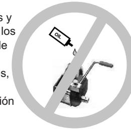
No lubrique el sistema de frenado del cabestrante, el mecanismo podría perder efectividad.
