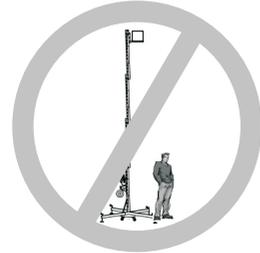
No permanezca debajo de la torre después de su elevación ya esté o no cargada, ni durante el proceso de descenso.
