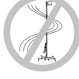
No use la torre en condiciones de fuerte viento. Tenga en cuenta que si la superficie y altura expuesta es máxima, la estabilidad de la torre se reduce.
