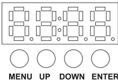
Presione el botón MENU (una o varias veces) hasta llegar a la función deseada (según el siguiente cuadro), y presione ENTER para confirmar su selección. Utilice los botones UP y DOWN para navegar entre cada función para seleccionar el valor correcto. (Pulse ENTER para confirmar la configuración).
