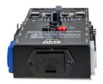
Comprobación de la batería: Gire el mando giratorio a "Battery Check", si el LED verde no se ilumina o parpadea, indica que la batería necesita ser cambiada.
